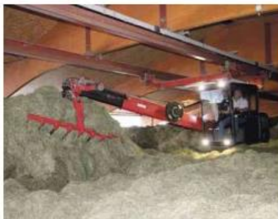
Juchée dans sa nacelle suspendue à deux rails, Pascal pilote avec facilité sa griffe télescopique
