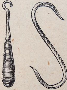
Les outils du tueur : Crochet servant à arracher les soies, N° C. 10096. Crochet servant à ouvrir et à suspendre le cochon, N° A. 15022.
